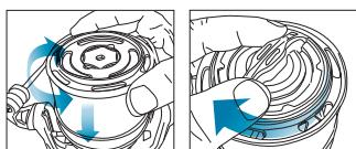
Faites glisser la bobine sur l'axe principal et tournez le bouton de frein dans le sens des aiguilles d'une montre pour serrer et augmenter la pression de frein.
