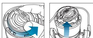
Tournez le bouton de frein dans le sens inverse des aiguilles d'une montre pour desserrer et retirer la bobine de l'axe.
