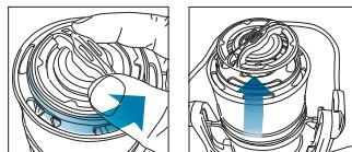
Draai de slipknop tegen de klok in om de spool los te maken en van de spoelas te trekken.
