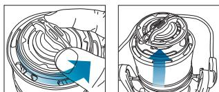
Drehen Sie den Bremseinstellknopf gegen den Uhrzeigersinn, um die Spule zu lösen und abzunehmen.
