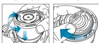
Deslice el Bobina sobre el eje principal y Gire el tapón de ajuste en el sentido de las agujas del reloj para ajustar y aumentar la presión del freno.
