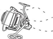
\* Затяните гайку фрикциона перед промывкой.
