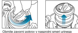
Obmrite zavorni pokrov v nasprotni smeri urinega kazalca, da sprostite in odstranite tuljavo z osi..
