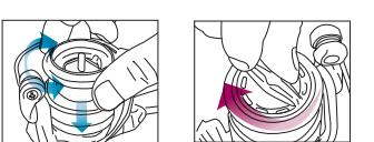
Navlékněte cívku na hlavní osu a otáčejte brzdovou matici ve směru hodinových ručiček pro utažení a zvýšení brzdné sily.
