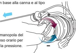
Ruotare la manopola del freno in senso orario per aumentare la pressione.
