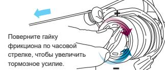
Поверните гайку фрикциона по часовой стрелке, чтобы увеличить тормозное усилие.
