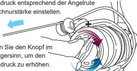
Drehen Sie den Knopf im Uhrzeigersinn, um den Bremsdruck zu erhöhen.
